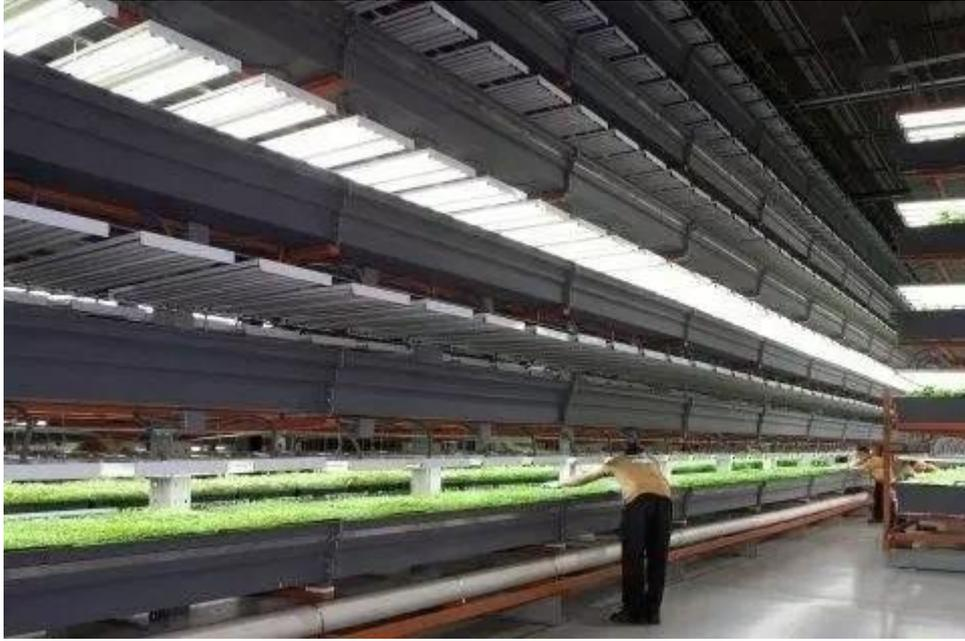
该农场内部采用了飞利浦 LED 的“光配方”来精确控制产量。在使用这些设备后，该农场内的卷心菜、甘蓝菜、罗勒属植物以及香葱这些产物一年中将能有 20-25 次采收，同时节省 85% 的能源。
