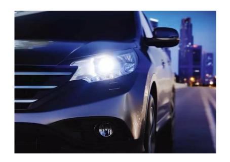
借助数千个可独立控制的光点,新型智能自适应前照灯可在充分照亮环境的同时,防止对其他车辆产生眩光。内含 1,024 个可独立控制光点的新型 LED 芯片只有指甲盖大小。三个同类芯片组合起来,便可使每个前照灯实现 3,072 像素的分辨率。
