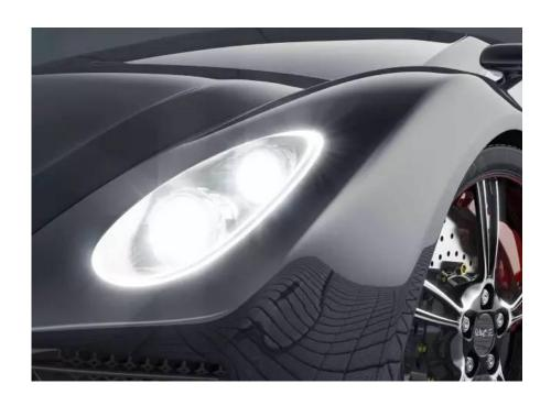
该模型的两盏前照灯分别包含三个 LED 光源,每个 LED 光源由 1,024 个可独立控制的光点组成。这意味着前照灯可根据相应的交通状况,十分精确的进行自适应调节,时刻保持最佳光照条件,避免让其他驾驶员感到炫目。
